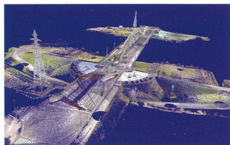
レーザー計測による3次元モデル
